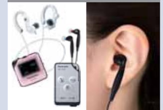
※ RIC (Receiver in Canal)：イヤホン(レシーバ)を補聴器本体から独立させて耳に入れるタイプの補聴器。
